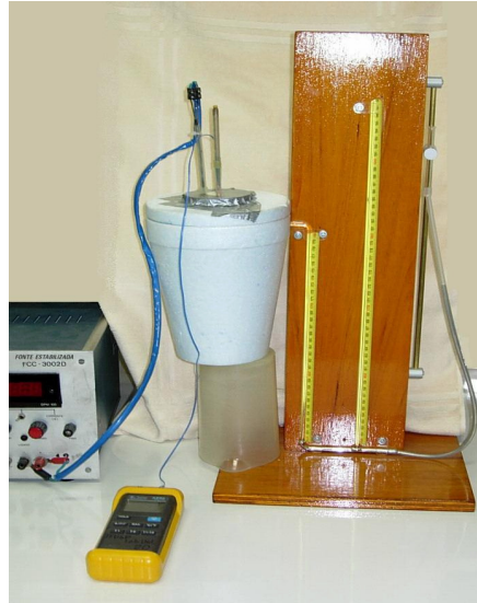
Figura 2: Fotografia do arranjo experimental exato utilizado no experimento. O termômetro a gás a volume constante, que se apóia numa base de madeira; o termômetro digital; o isopor adaptado com o mexedor e a resistência, para dissipar pouca energia; a fonte, na qual se liga a resistência.
