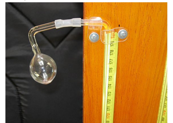
Figura 5: Fotografia da ligação entre o bulbo de vidro e o capilar com o mercúrio, feita com uma mangueira plástica deformável. A deformação da mangueira causou diferenças nos resultados esperados para a pressão do gás a volume constante.
